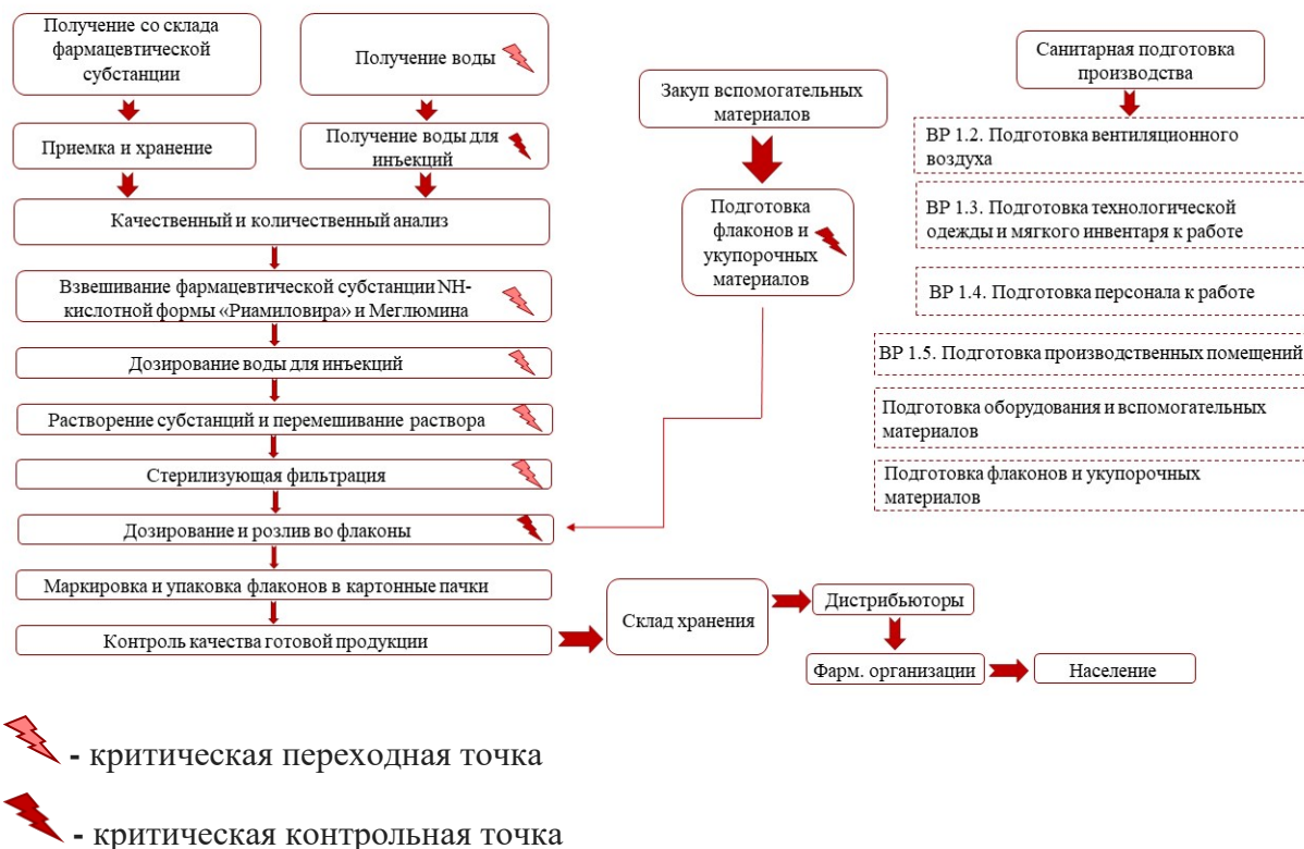
Рисунок 2. Производственная блок-схема раствора для ингаляционного введения на основе действующего вещества «риамиловир»
